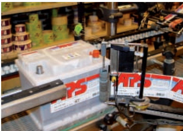
Logística. Etiquetado automático de baterías
