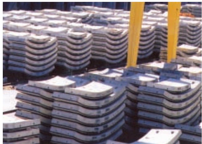
Dovelas prefabricadas para el revestimiento de túneles
